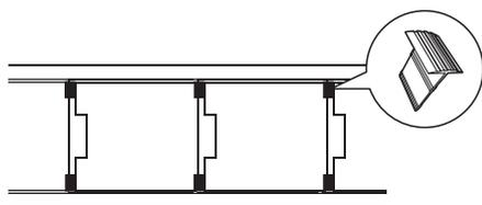
6 木製ハンマーで隙間にクサビを打ち込む
