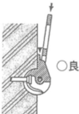
直角方向に吊る場合の作動状況
