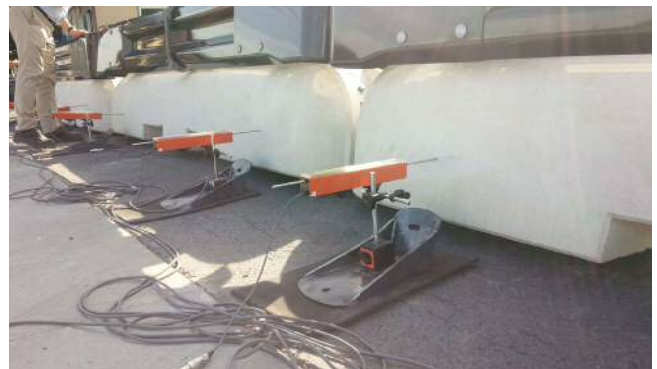
ブロック3本が一緒に浮き上がっています。
