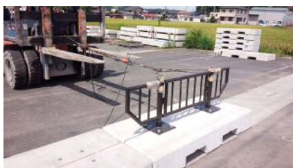
耐荷重試験状況
